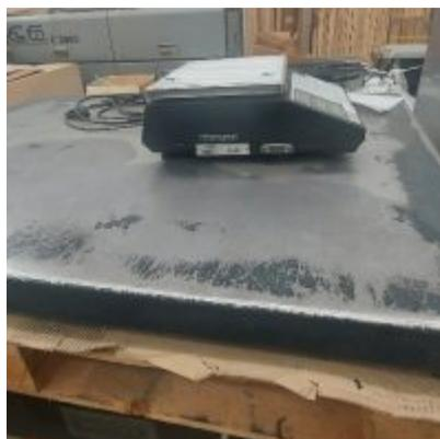
Bilancia elettronica Eurobil modello DS-400, portata 30kg, con presa seriale e Piano Pesa esterno 1.000×1.000.
