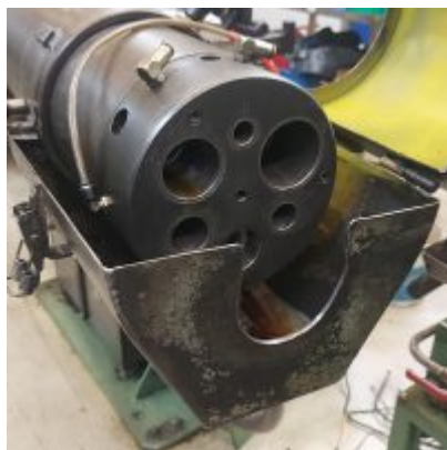
Spingibarra tubo ASMUT usato Spingibarra Asmut a bagno d'olio, per Tornio cnc. Passaggio barra 15-22-29-36-43-46
